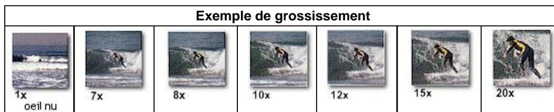
Pour les grossissements au-delà de 10 fois, l'objet observé n'apparaît pas clairement à cause de l'instabilité des jumelles (dû à un léger tremblement des mains); il faut les mettre sur un trépied.
